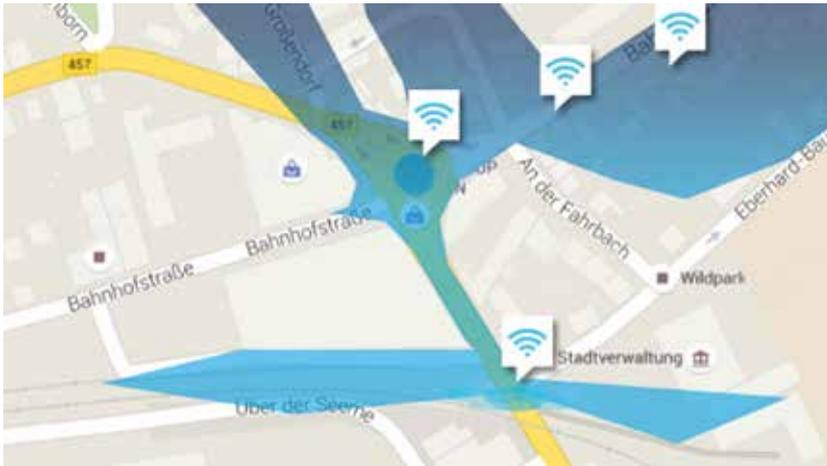
Mittels Simulationssoftware werden die optimalen Standorte der WLAN Sendepunkte berechnet und simuliert.
